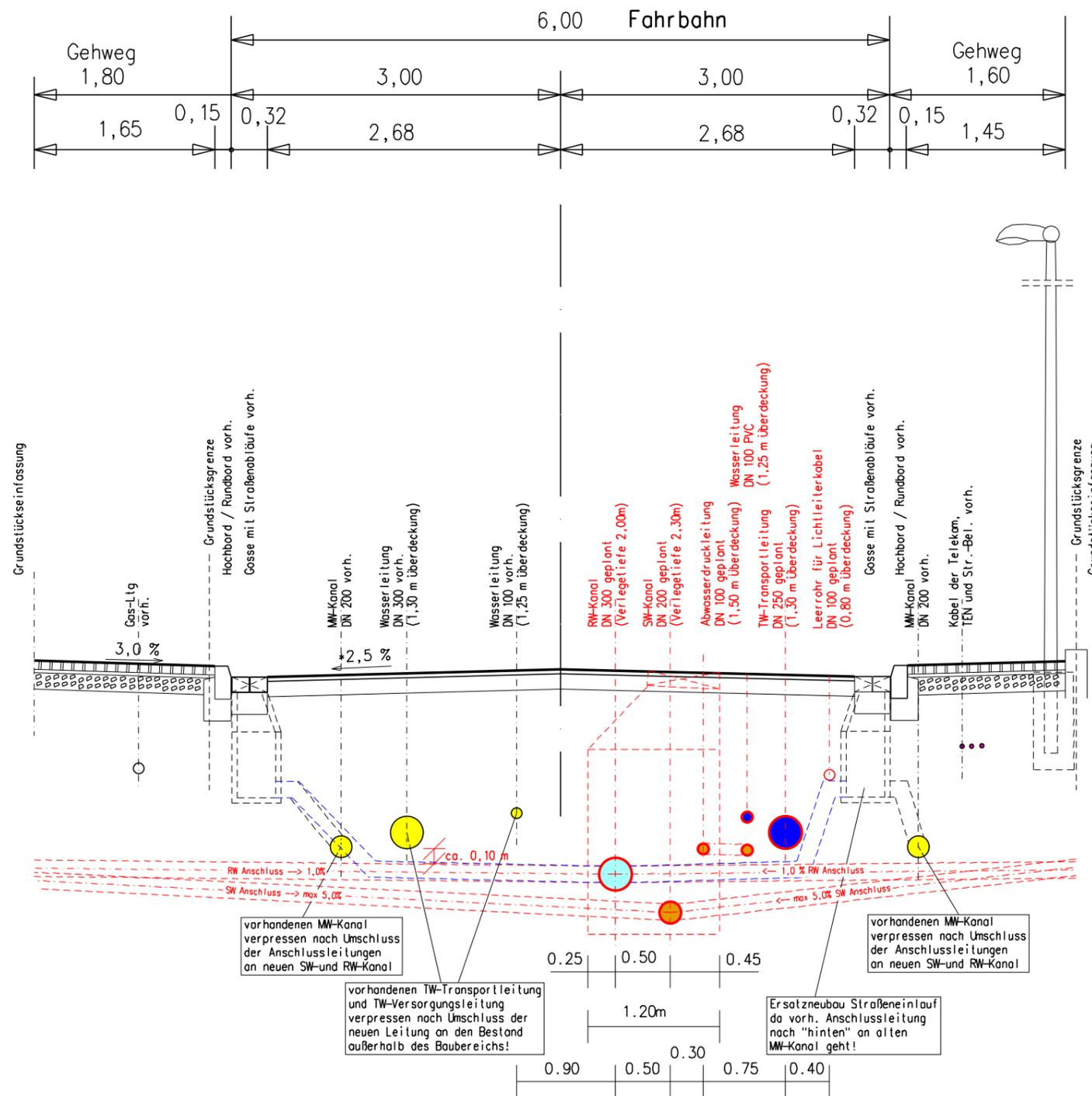
Die Abstände der einzelnen Medienleitungen entsprechen teilweise nicht den Forderungen des DVGW-Arbeitsblattes W 400-1. Die hier dargestellte mögliche Leitungsverlegung ist durch den WAZ Eichsfelder Kessel als Auftraggeber zu prüfen und zur weiteren Bearbeitung zu bestätigen.
