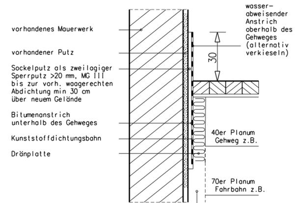
vorhandene Abdichtung bei Beschädigung erneuern. min. bis > 15 cm unter Bodenplatte (Keller) min. bis zum Fundament (ohne Keller)
